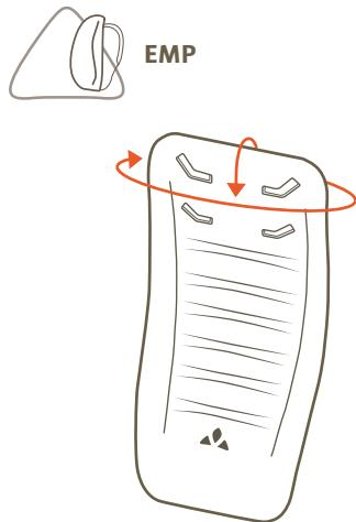
**Ergonomic Movement Panel:** eine leichte, ergonomisch geformte Rückenplatte. Die Konstruktion erlaubt Bewegungen nach vorne und stabilisiert nach hinten. Sie stabilisiert die Tragelast und erhöht die Packstabilität des Rucksackes.
