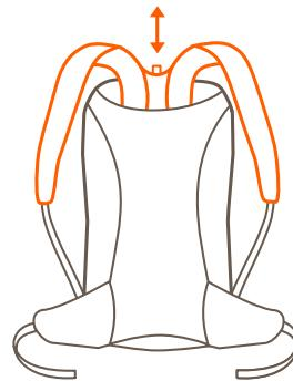
Mit der „Shifting Back Length“ lässt sich die gesamte Rückenlänge des Rucksackes stufenlos an den Nutzer anpassen - für das extra Plus an Komfort auf allen Touren.
